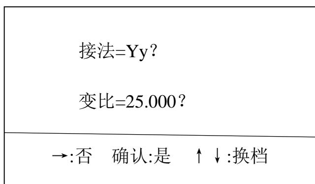
每按“↑”键一次，变比增加 $25.000 \times 5\%$ ，即1.25。每按“↓”键一次，变比减少1.25。新的标准变比直接显示在屏上，按确认键，即可测量出结果。
