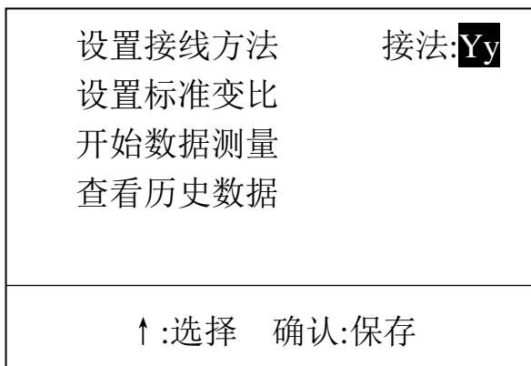
4. 设置标准变比,进入标准变比设置后,液晶屏显示如下
